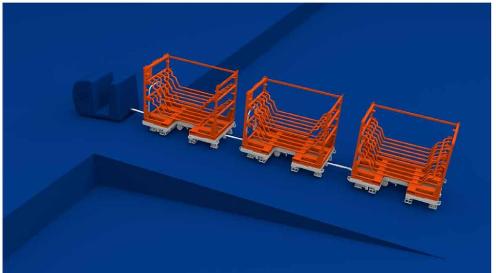
Durch die beiden Bockrollen in der Mitte des Wagens wird dieser nicht nur routenzugfähig, sondern auch rampenfähig. Beim Absenken der Deichsel zur Kopplung der Wagen senken sich die Bockrollen automatisch ab, um stetigen Kontakt zum Boden zu garantieren. Durch die spezielle Konstruktion können mit dem R6+ Mk II Rampen mit einem Winkel von bis zu 5° befahren werden.
