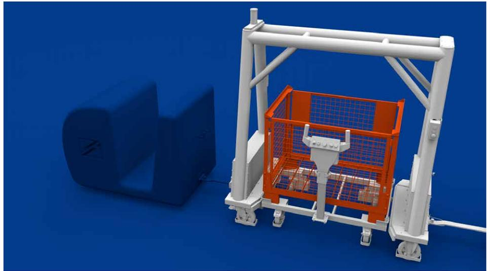
Das Cockpit ist abnehmbar und kann an verschiedenen Wagen verwendet werden, was die Flexibilität und Effizienz erhöht.
